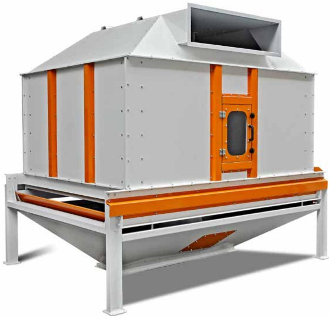
**Tr** Pelet presinde mekanik sürtünme eli ısısı yükseltmiş mamülün soğutularak kullanıma hazır hale getirilmesini sağlar. Ters hava akımlı, Üç ızgaralı, iki ızgarası hareketli. Boşaltma hızı mamül sıcaklığı ayar edilebilir. Hava debi ayarı yapılabılır. Pelet dağıticisi. Şeffaf kontrol penceresi. 2 Adet seviye kontrol sensörü. Toplama hoperi
