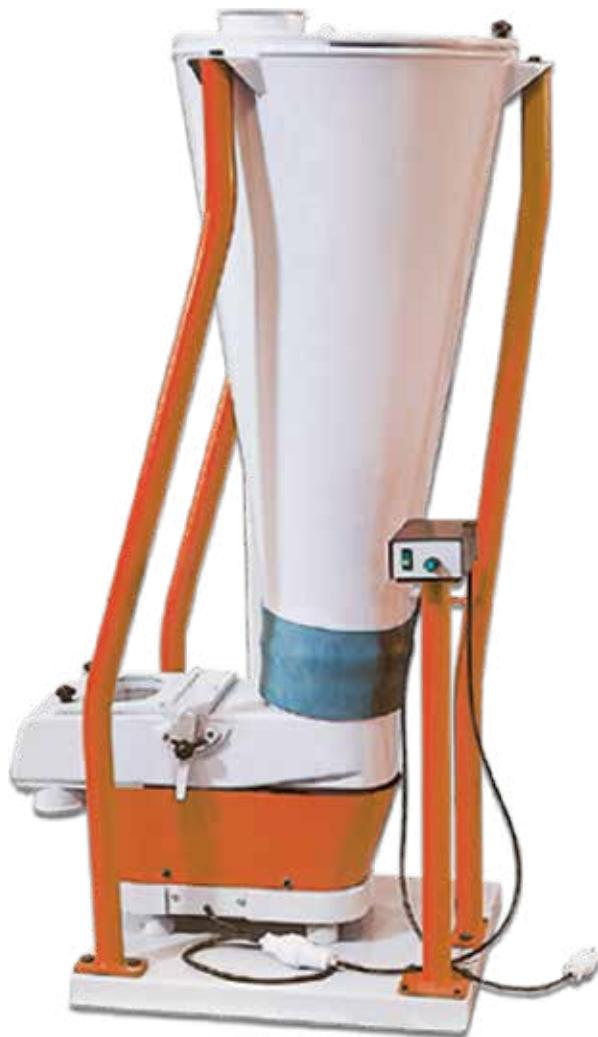
**Tr** Makinelerin içinden çıkan un ve kepek benzeri ürünlerin tekrar fabrikaya katılmasını sağlar.
