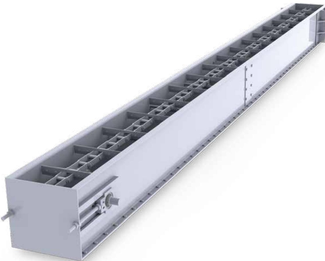
**Tr** Zincirli konveyör zincirlerin tahrik edilmesi ve bu sayede zincirlere takılabilen taşınacak malzemeye uygun apparatlar ile taşımayı sağlayan konveyör sistemleridir. Zincirli konveyörler yüksek kapasitelerde mal aktaran ve yüksek dayanımlı taşıyıcılardır. Zincirli konveyörlerde taşıma yapılacak malzemenin boyutuna ve ağırlığına uygun zincir seçilir. Zincirli konveyörler 3 ana bölümden oluşur:
