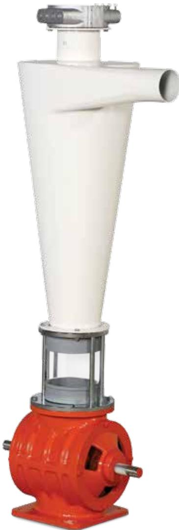
**Tr** Pnömatik Siklon Grubu, dökülen ürünü hava akımıyla hareket ettiren bir sistemdir. Taşıma işlemi borular içinde yapılmaktadır ve taşınan materyaller Pnömatik Siklon'a gönderilmektedir. Siklonlar çelik sac konstrüksiyondan imal edilmiştir. Silindirik konik gövdeli olup giriş ve çıkış borusundan ibarettir. Pnömatik sisteme hava ile mamulün ayrışması esnasında sistemin hava kaybını minimum düzeyde tutacak şeklinde dizayn edilmiştir.
