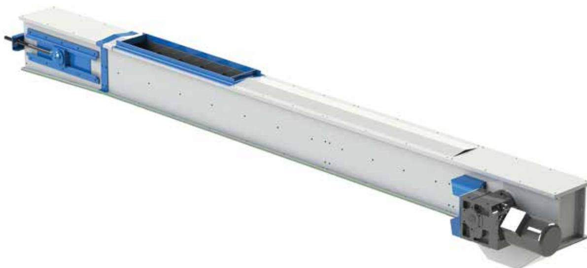
**Tr** Yem, gıda, kimya, gübre ve toprak gibi tesislerde hammadde ve mamullerin yatay ve belirli dereceye kadar eğimli olarak götürülmesini sağlayan taşıyıcıdır . Taşıma işlemini ring hareketi yapan özel tip zincirin mali sürükleme ile yapmaktadır. Dişli ve ya kaplin olarak değişiklik gösterebelen güç aktarma organları. Talebe göre değişen paslanmaz, galvaniz veya siyah sacdan imal edilir.
