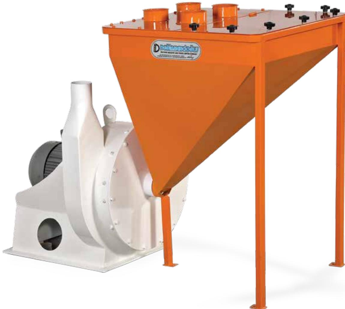
**Tr** Ün fabrikalarında çıkışları kırmak için kullanılır. Başak, kapçık vb. çıkışları kırmak için kullanılır. Makine çekiçler ve fan motora akuple olarak çalışır. Kırılan ürün fan sayesinde istenilen yere taşınır. Kırıcı fanı maksimum 50 metre gönderme yüksekliğine sahiptir. Makinenin besleyici deposu ve kullanacağı siklon makine ile beraber verilmektedir Gövde kalınlığı 4 mm, bıçaklar özel imalat çeliğinden imal edilmiştir. Makinenin statik balansı alınmış olup sessiz çalışır
